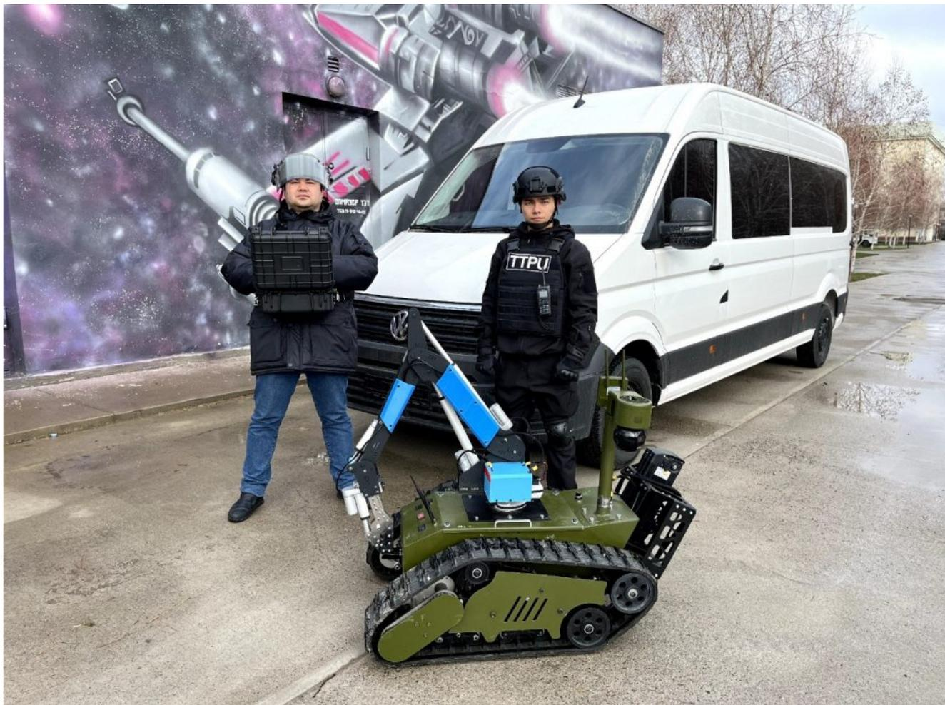
Управление робототехническим комплексом осуществляется как по кабелю, так и по радиоканалу, в зависимости от имеющейся обстановки. Длительность непрерывной работы робота составляет от двух до четырех часов. Гусеничная платформа позволяет «Zirhli Tulpor» преодолевать пороги высотой 250 мм и водные преграды глубиной до 200 мм.
