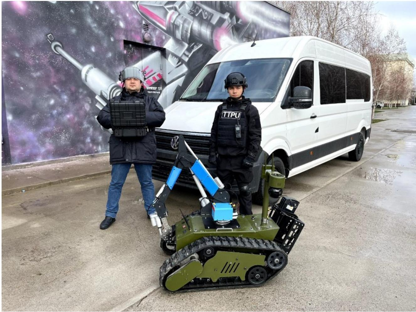
Robot majmuasini boshqarish mavjud vaziyatga qarab ham kabel, ham radio orqali amalga oshiriladi. Robotning uzluksiz ishlash muddati ikki soatdan to'rt soatgacha. Tırtıl platformasi Zirhli Tulporga 250 mm balandlikdagi ostonalar va 200 mm chuqurlikdagi SUV to'siqlarini yengib o'tishga imkon beradi.
